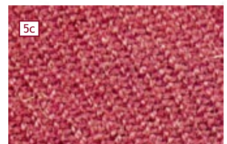
[5] Tessuti ad armatura saia. a) saia 2/2; b) saia 2/1; c) aspetto del tessuto.
